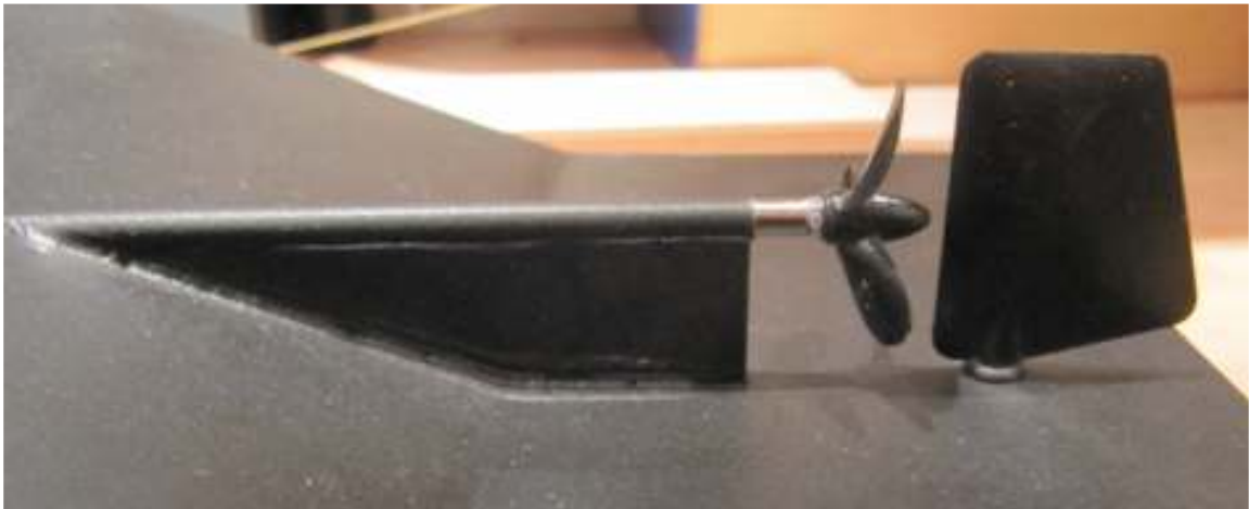
Bild 30: Spiegel zur Abstützung des Schiffswelle.
