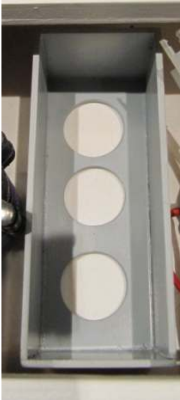
Bild 38: Beispiel für eine Batteriebox aus ABS Kunststoff.
