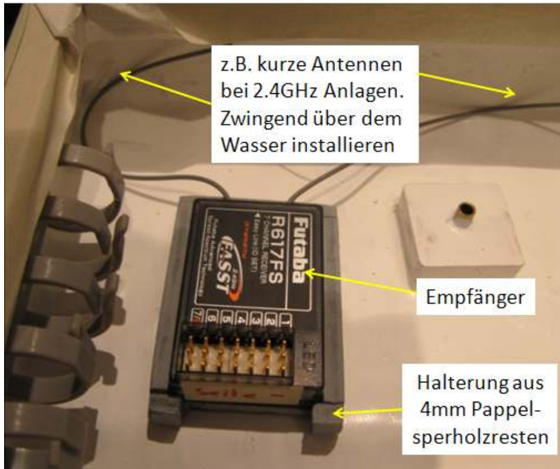
Bild 40: Empfänger im Modell.
