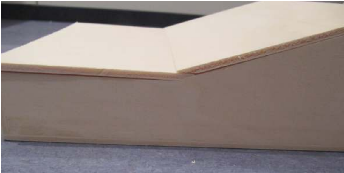
Bild 16: Schrägschleifend des hinteren Teils.
