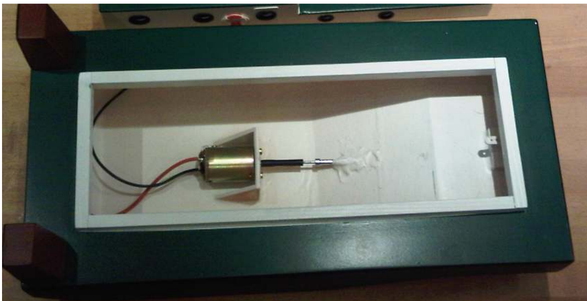
Bild 33: fertig eingebaute Antriebseinheit.
