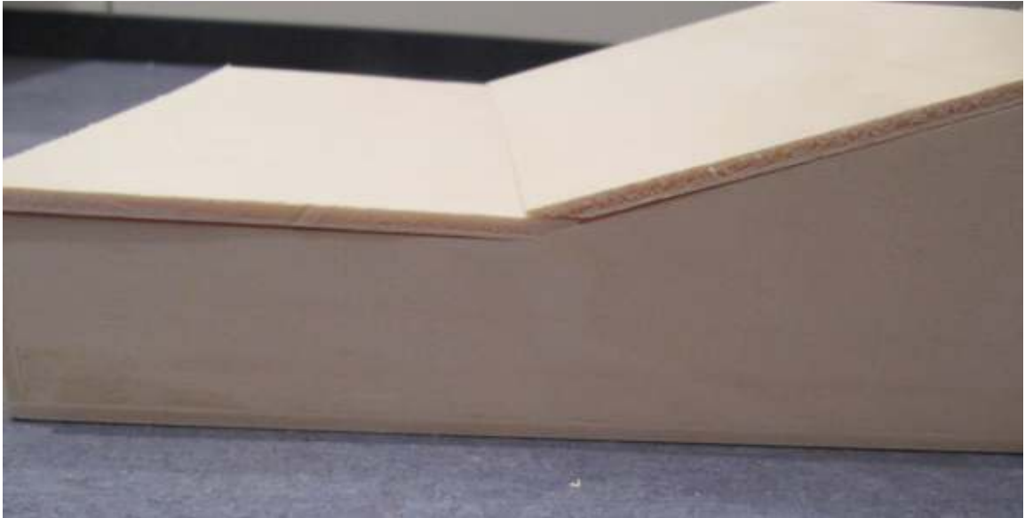
Bild 18: Schrägschleifend des hinteren Teils.
