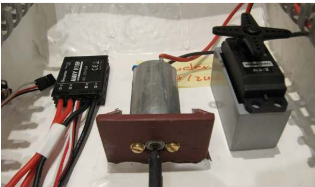
Bild 39: Regler und Servo bei der Stellprobe. Wenn es passt, kann montiert werden
